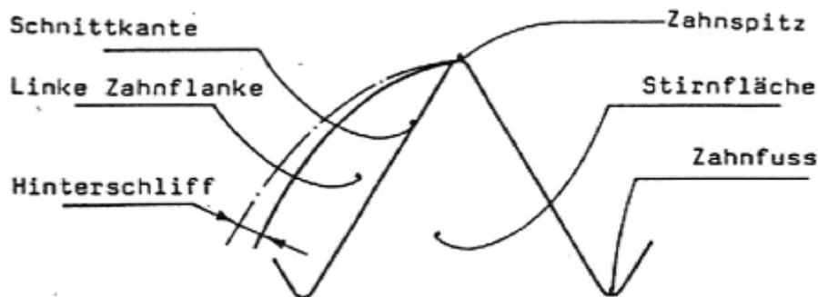
Grundsätzlich unterscheidet man den Anschnitt „vor“ dem Zahn und „nach“ dem Zahn. Der Zahn vor dem Anschnitt zentriert die Kernbohrung während des Schneidens. Die Zähne nach dem Anschnitt dienen allein zur Führung und verjüngen sich in der Regel gegen den Schaft um unnötige Reibmomente und Spanklemmer zu vermeiden.
