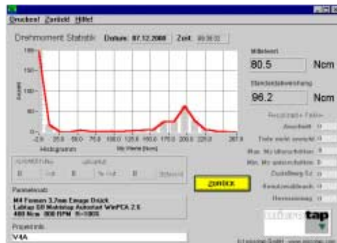
Drehmoment Statistik nach Gauß für aktuellen Schnitt
